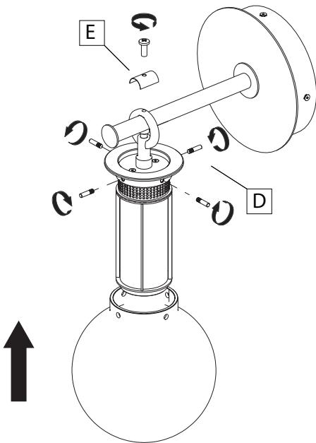
**ES** Desenroscar las piezas de fijación (D) del cuerpo principal. Posicionar el difusor de cristal y fijarlo rosando nuevamente las piezas (D). Retirar el tornillo de seguridad y el protector (E).
