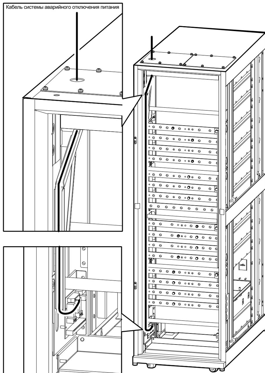
ИБП должен быть подключен к сухому контакту или внешнему источнику 24 В постоянного тока.
