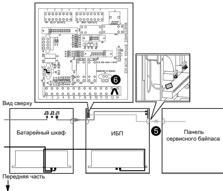
6. Для распределительных устройств сторонних поставщиков без контроля состояния необходимо убрать перемычку между контактами 13 и 14 порта J2. Для распределительных устройств с контролем состояния, подключенных к плате интерфейса сервисного байпаса, необходимо оставить данную перемычку установленной.
