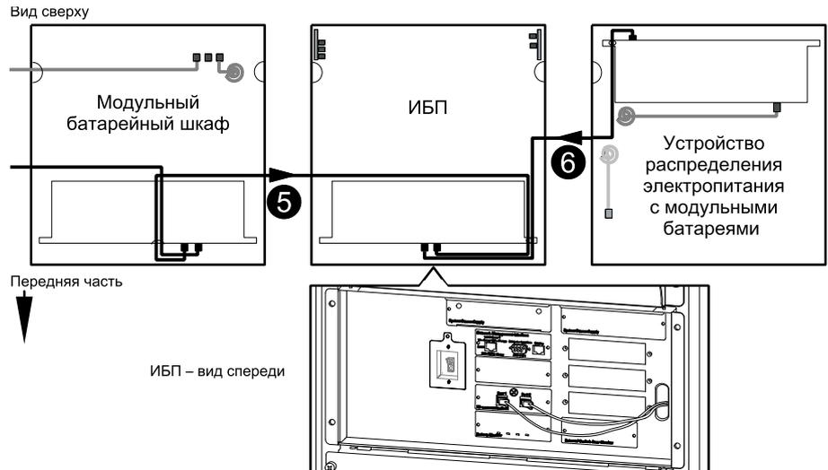
7. Проложите три коммуникационных кабеля устройства распределения электропитания от устройства распределения электропитания с модульными батареями к J7, J8 и J1 на плате сервисного байпаса (ОРЗ199) в ИБП.
