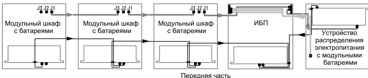
1. Проложите кабель отключения размыкателя батарейного автомата от J1 в первом модульном батарейном шкафу к J3 в следующем модульном батарейном шкафу. Повторите процедуру для всех модульных батарейных шкафов.
