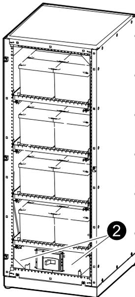
3. Снимите винты защитной металлической пластины и клеммную колодку на правой стороне батарейного шкафа, и вытащите их.
