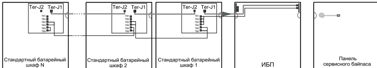
8. Прикрепите сигнальные кабели к нижней металлической пластине в стандартном батарейном шкафу и к панели с фиксаторами в ИБП с помощью кабельных стяжек.
