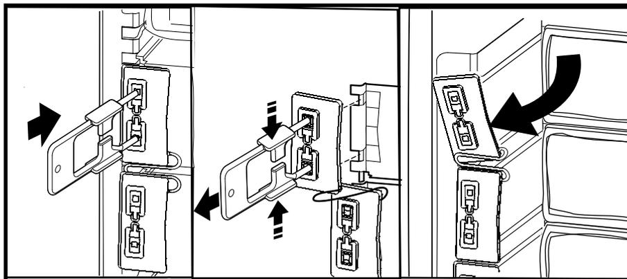
5. Для демонтажа панелей-заглушек: Нажмите на зажим панели-заглушки, чтобы открыть блокирующий механизм и осторожно потяните панель на себя.
