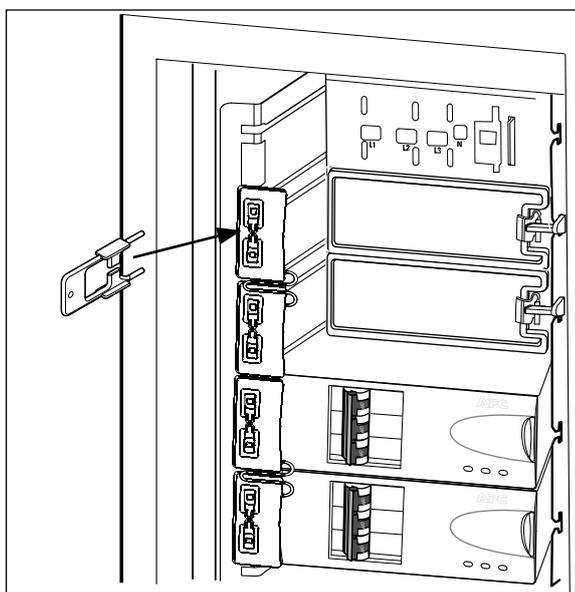
3. Сожмите боковые стороны ключа и вставьте его внутрь до плотного соединения с замком.
