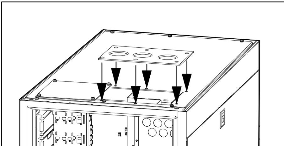
3. Установите верхнюю панель со смонтированными изоляционными трубами на место.
