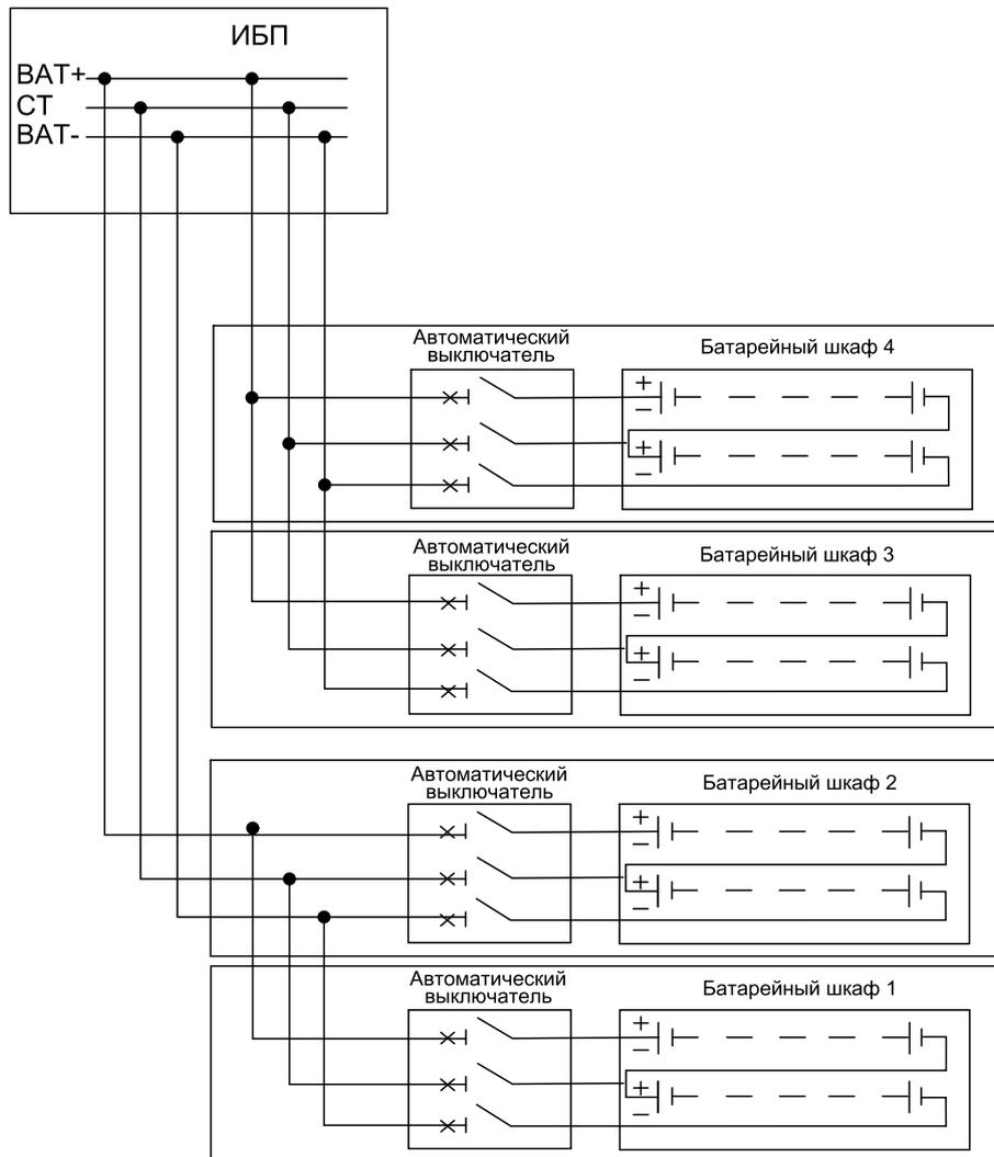
7. Подключите кабели батарей ВАТ+, ВАТ- и СТ к ВЫХОДУ батарейного автомата в стандартной батарейном шкафу, который будет подключен к ИБП, и проложите кабели через нижнюю часть стандартного батарейного шкафа. Прикрепите кабели к нижней металлической пластине шкафа с помощью кабельных стяжек.
