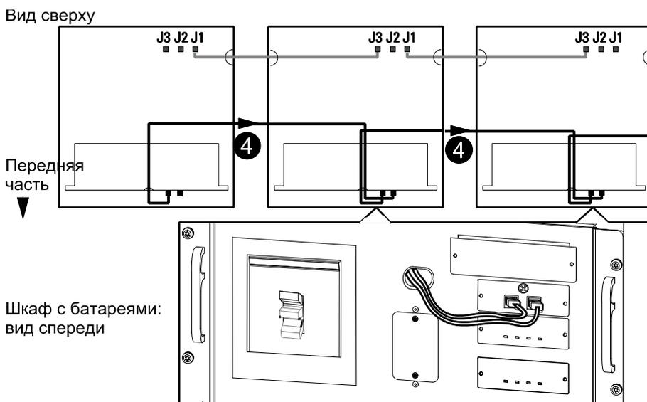
5. Проложите коммуникационный кабель от внешнего коммуникационного порта 1 последнего модульного батарейного шкафа в ряду к порту 2 контроля внешних батарейных шкафов в ИБП
