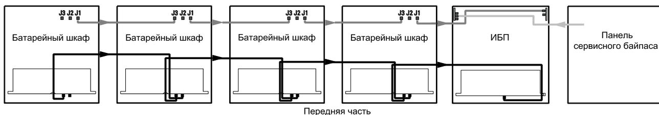
1. Проложите кабель отключения размыкателя батарейного автомата от J1 в первом модульном батарейном шкафу к J3 в следующем модульном батарейном шкафу. Повторите процедуру для всех модульных батарейных шкафов.
