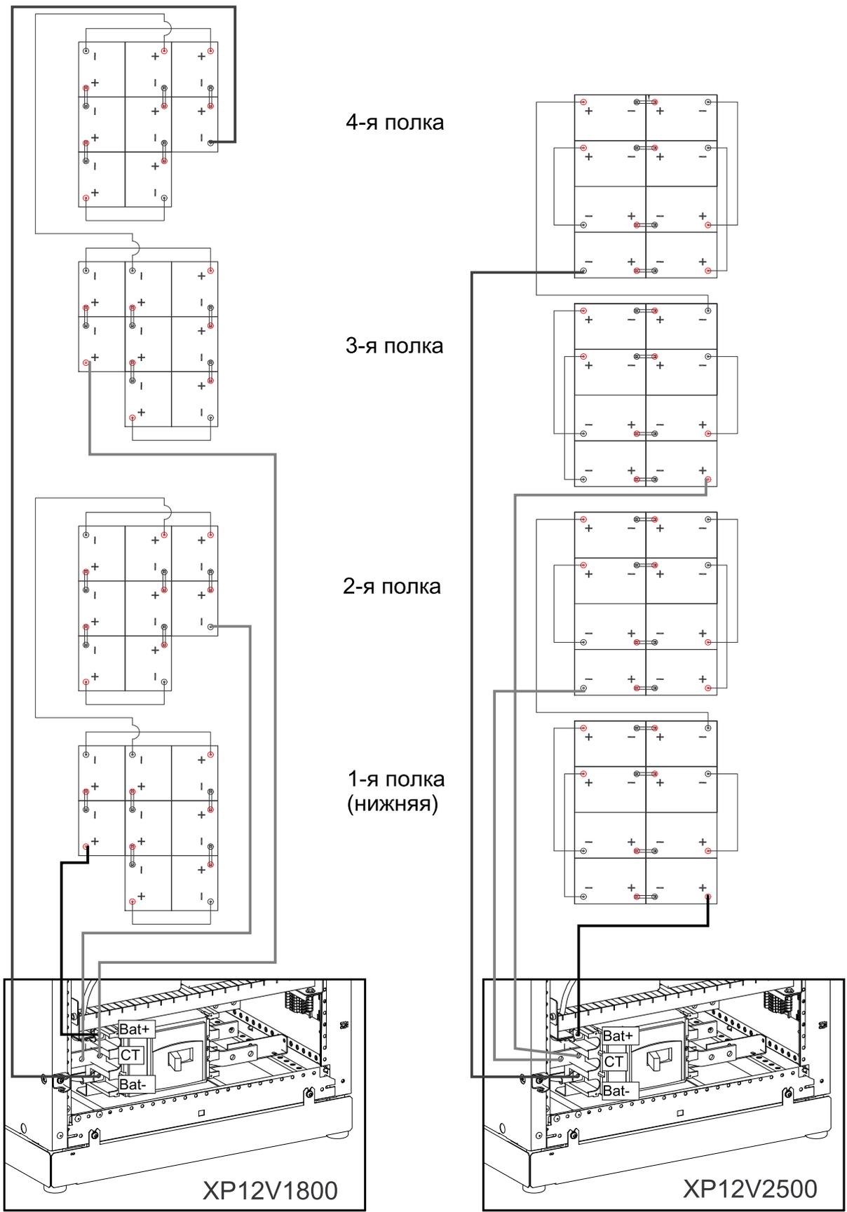
6. Если установлено более одного стандартного батарейного шкафа: Подключайте кабели BAT+, BAT- и СТ (средняя точка) между стандартными батарейными шкафами параллельно (выход к выходу) в группах по 2 или 3. К ИБП можно подключить до 4 стандартных батарейных шкафов.
