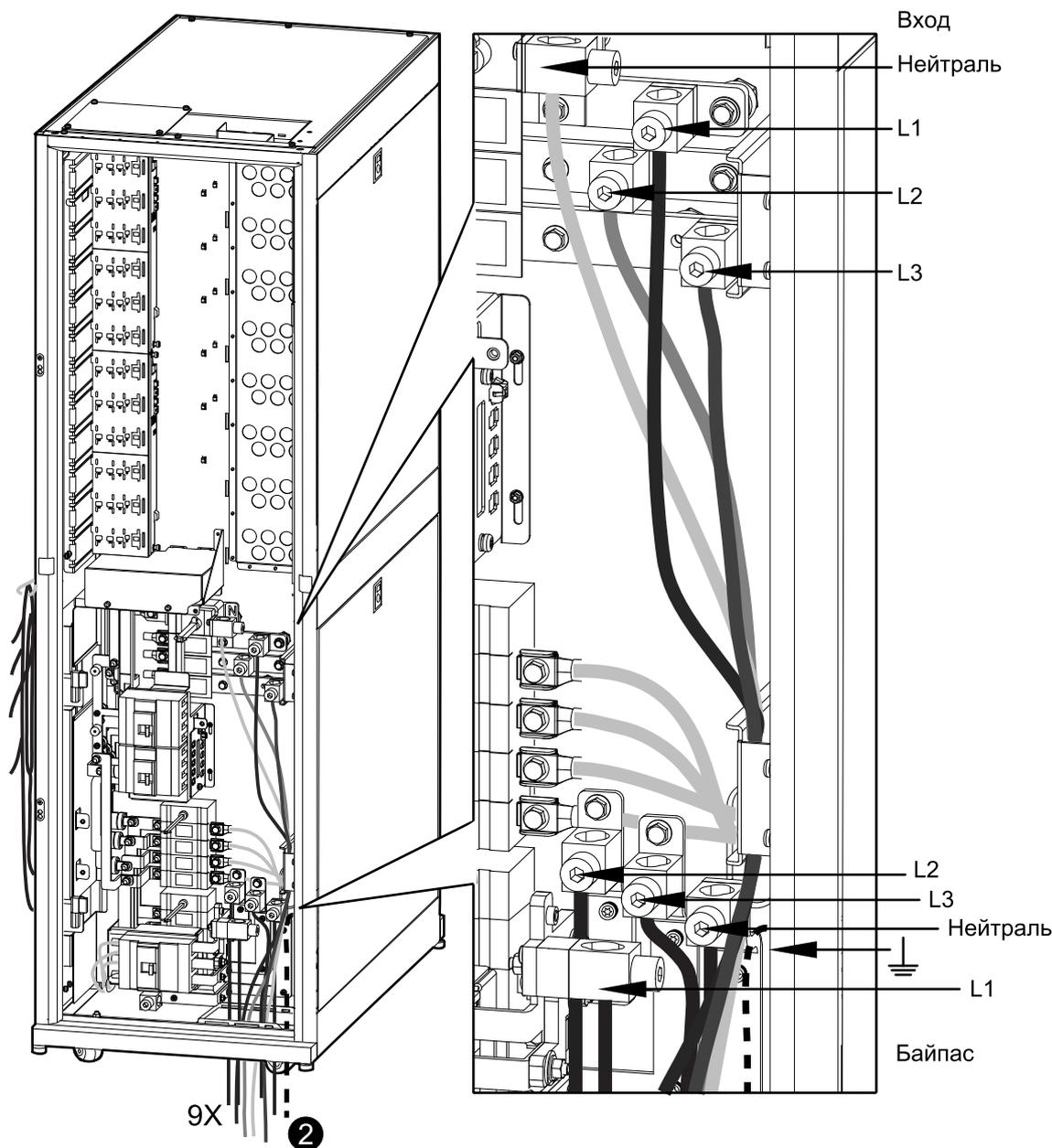
**Подключение выключателей отводящих линий устройства распределения электропитания**
