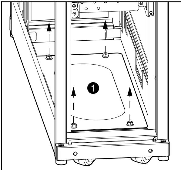
2. В случае необходимости просверлите в нижней панели отверстия для изоляционных труб и установите ее на место с уже установленными трубами.
