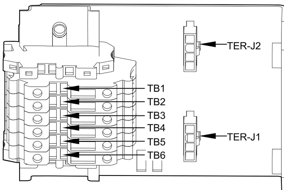
3. Проложите сигнальный кабель от клеммной колодки стандартного батарейного шкафа (ТВ1, ТВ2, ТВ3, ТВ4) к контактам разъемов печатной платы (J21/7, J21/8, J21/3, J21/6) в ИБП. Момент затяжки клеммных контактов составляет 0,6 Н•м.
