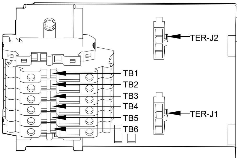
3. Проложите сигнальный кабель от клеммной колодки (ТВ6, ТВ5) в стандартном батарейном шкафу 1 к клеммной колодке (ТВ3, ТВ4) в стандартном батарейном шкафу 2.
