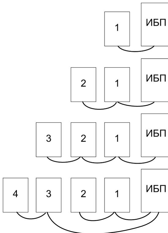
**Примечание:** Для подключения четырех батарейных шкафов к ИБП используется два набора кабелей батарей (по одному для каждой группы батарейных шкафов).
