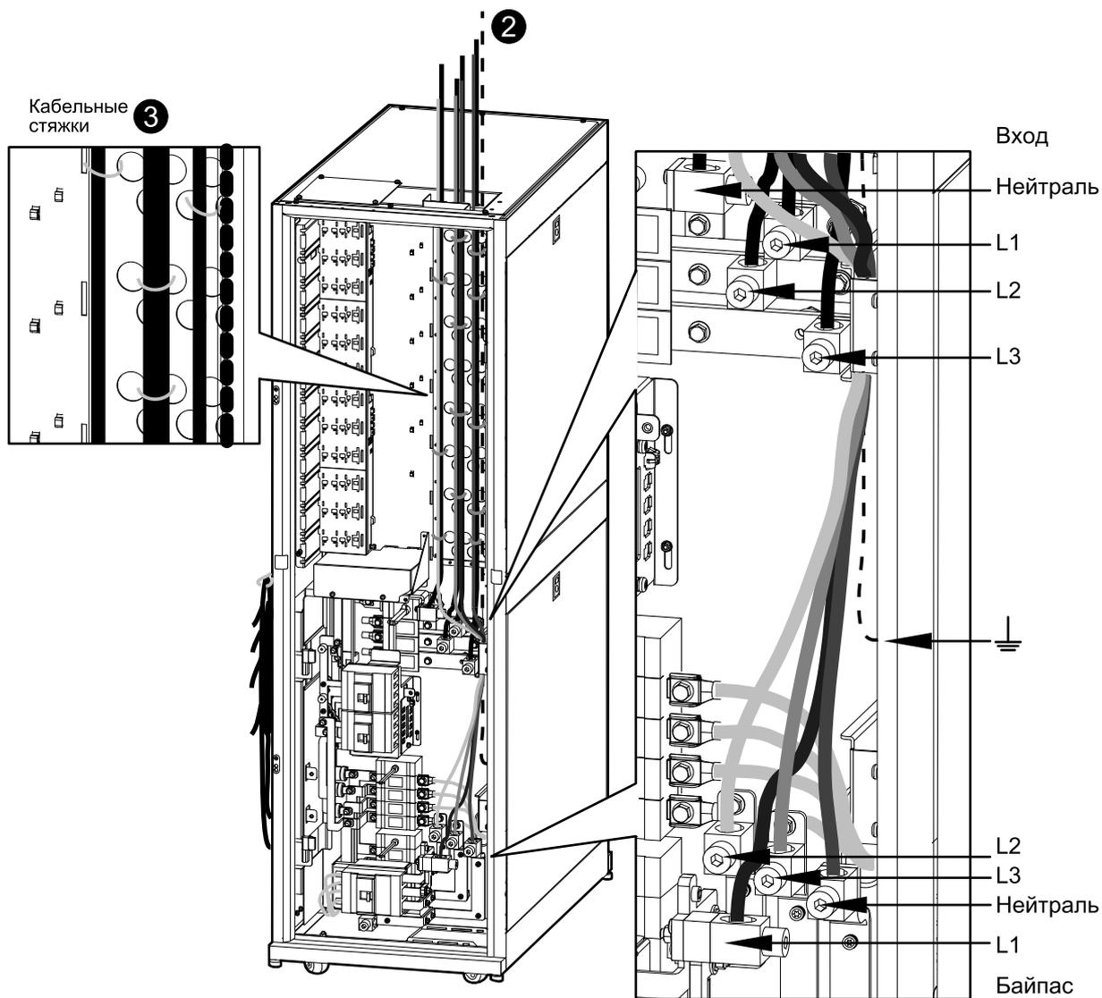
**Система с нижним кабельным вводом – устройство распределения электропитания с модульными батареями – вид спереди**
