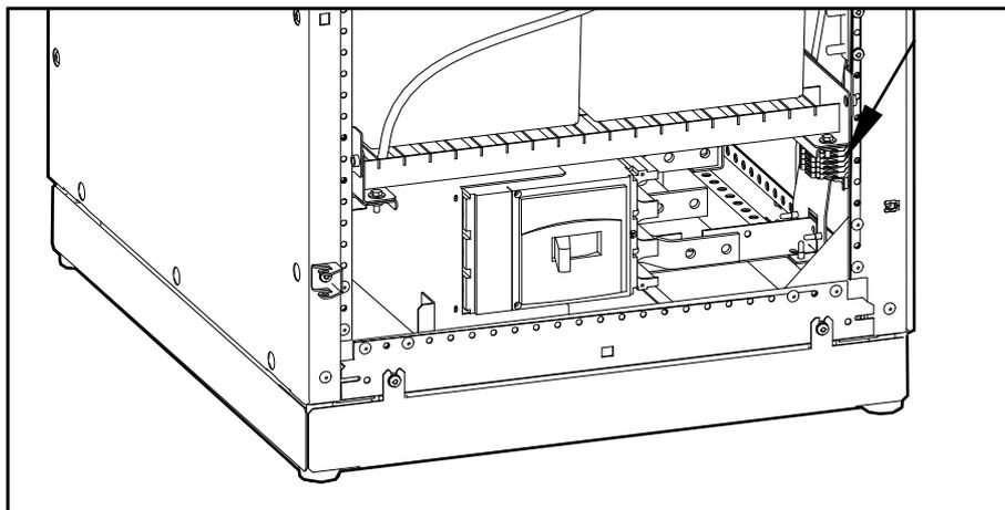
2. Отсоедините перемычку (ТВ5-ТВ6) на всех стандартных батарейных шкафах, кроме наиболее удаленного от ИБП стандартного батарейного шкафа.
