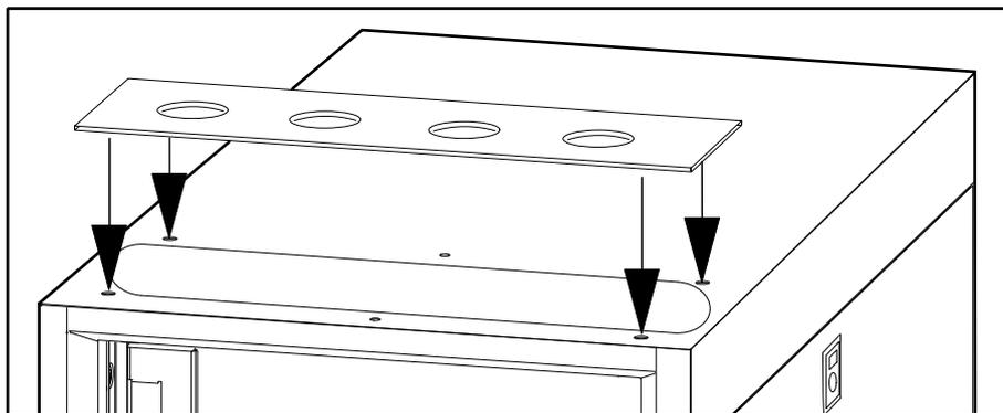
**Подготовка к прокладке кабелей в системах ИБП с верхним кабельным вводом без использования изоляционных трубок**
