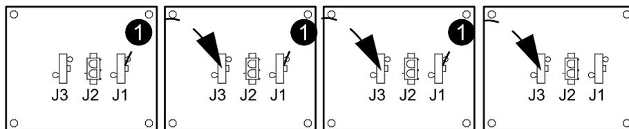
2. Проложите кабель отключения размыкателя батарейного автомата от J1 на последнем модульном батарейном шкафу к J27 на плате интерфейса системы аварийного отключения питания/вспомогательной платы интерфейса (OP4123) в ИБП.
