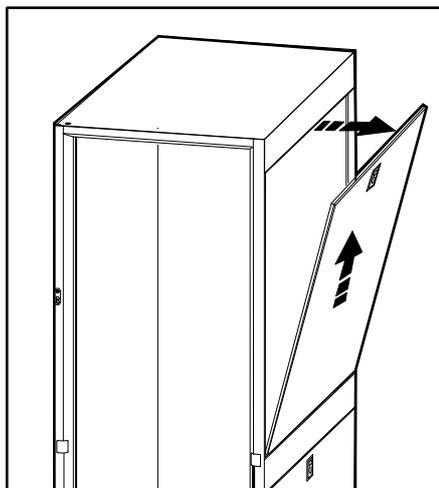
3. Чтобы установить боковые панели, разместите основание панели под углом и вдавите панель внутрь. Заблокируйте боковые панели с помощью ключа.
