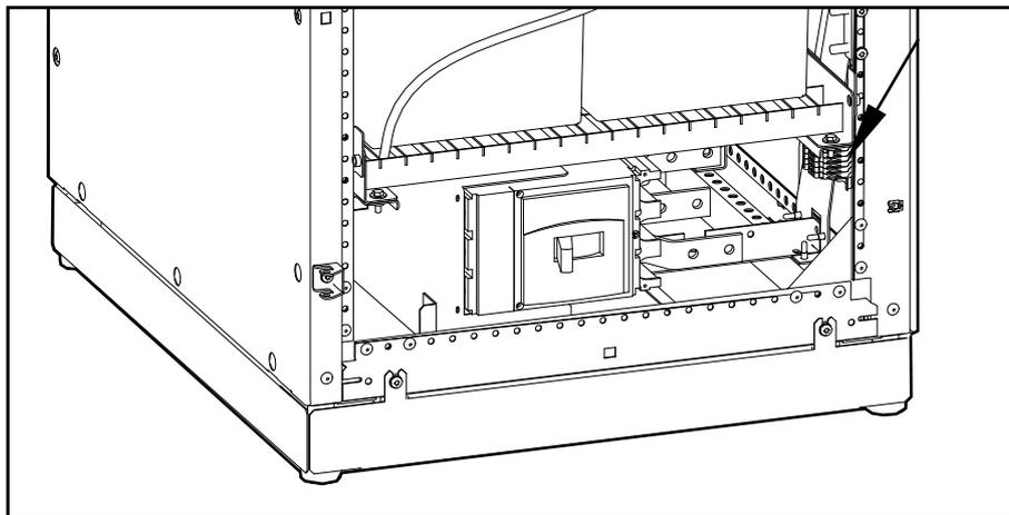
2. Проложите сигнальный кабель от клеммной колодки стандартного батарейного шкафа (Ter J1) к печатной плате (0P4123 J27) в ИБП.
