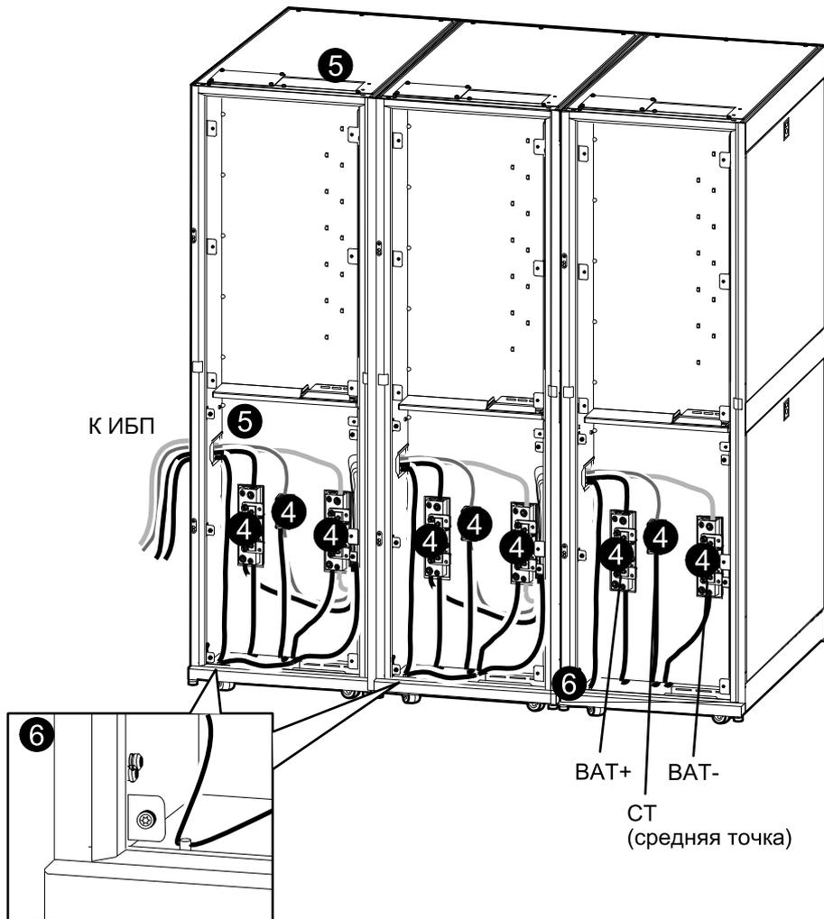
6. Подключите кабель заземления оборудования к модульному батарейному шкафу, расположенному на максимальном удалении от ИБП. Проложите этот кабель через другие модульные батарейные шкафы, подключая его от шкафа к шкафу и к ИБП через боковые, верхние или нижние отверстия в модульных батарейных шкафах.
