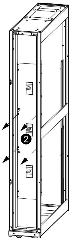
3. Выполните выравнивающее потенциалы соединение, соедините и выровняйте шкаф сервисного байпаса с другими шкафами (инструкции по выполнению этих действий см. в разделах Выполнение выравнивания потенциалов, стр. 43 и Соединение монтажных шкафов между собой, стр. 47).
