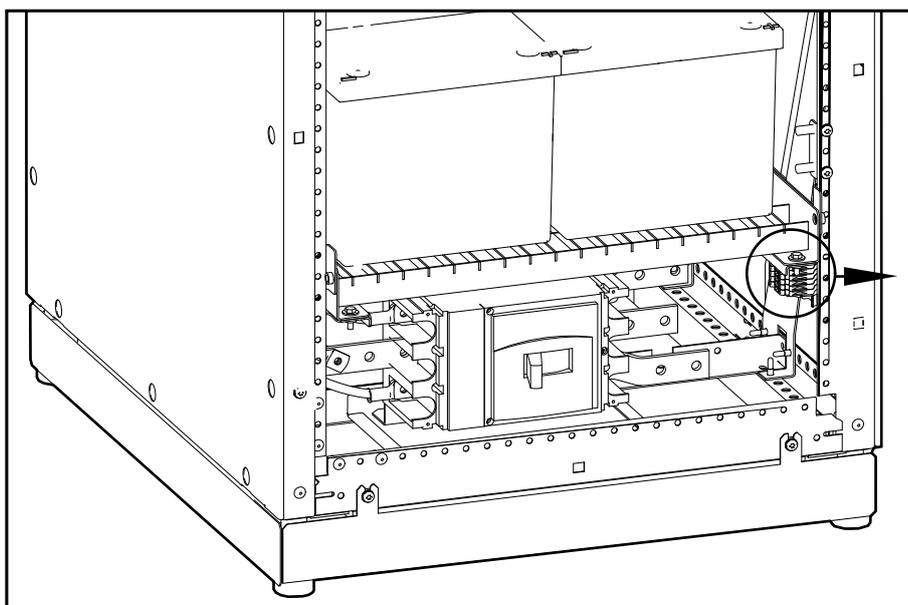
**Примечание:** Снимать металлическую пластину и клеммную колодку со шкафа для прокладки кабелей необязательно, но это облегчит прокладку ввиду ограниченного пространства в шкафу.
