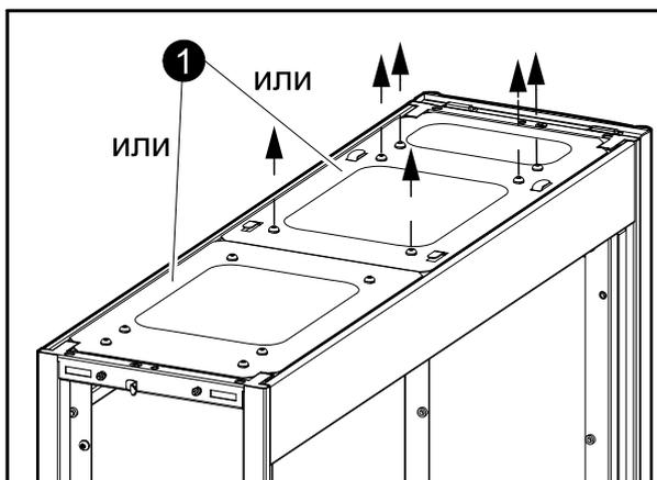
2. В случае необходимости просверлите в верхней панели отверстия для кабельных изоляционных труб и установите ее на место с уже установленными трубами.
