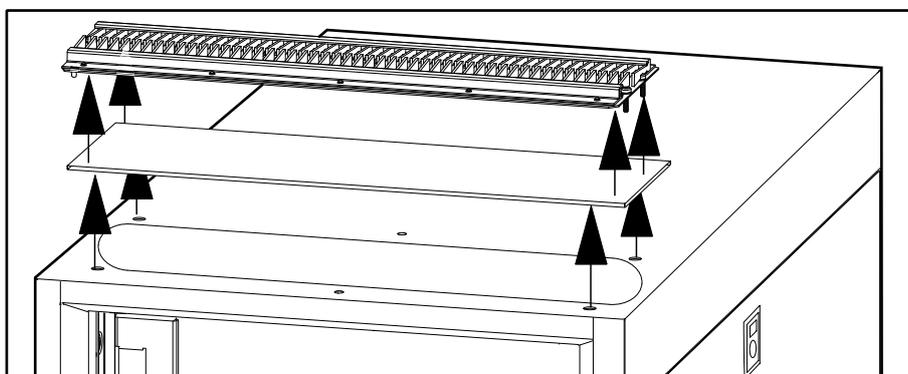
2. Просверлите в фальш-панели требуемое количество отверстий и установите изоляционные трубы.
