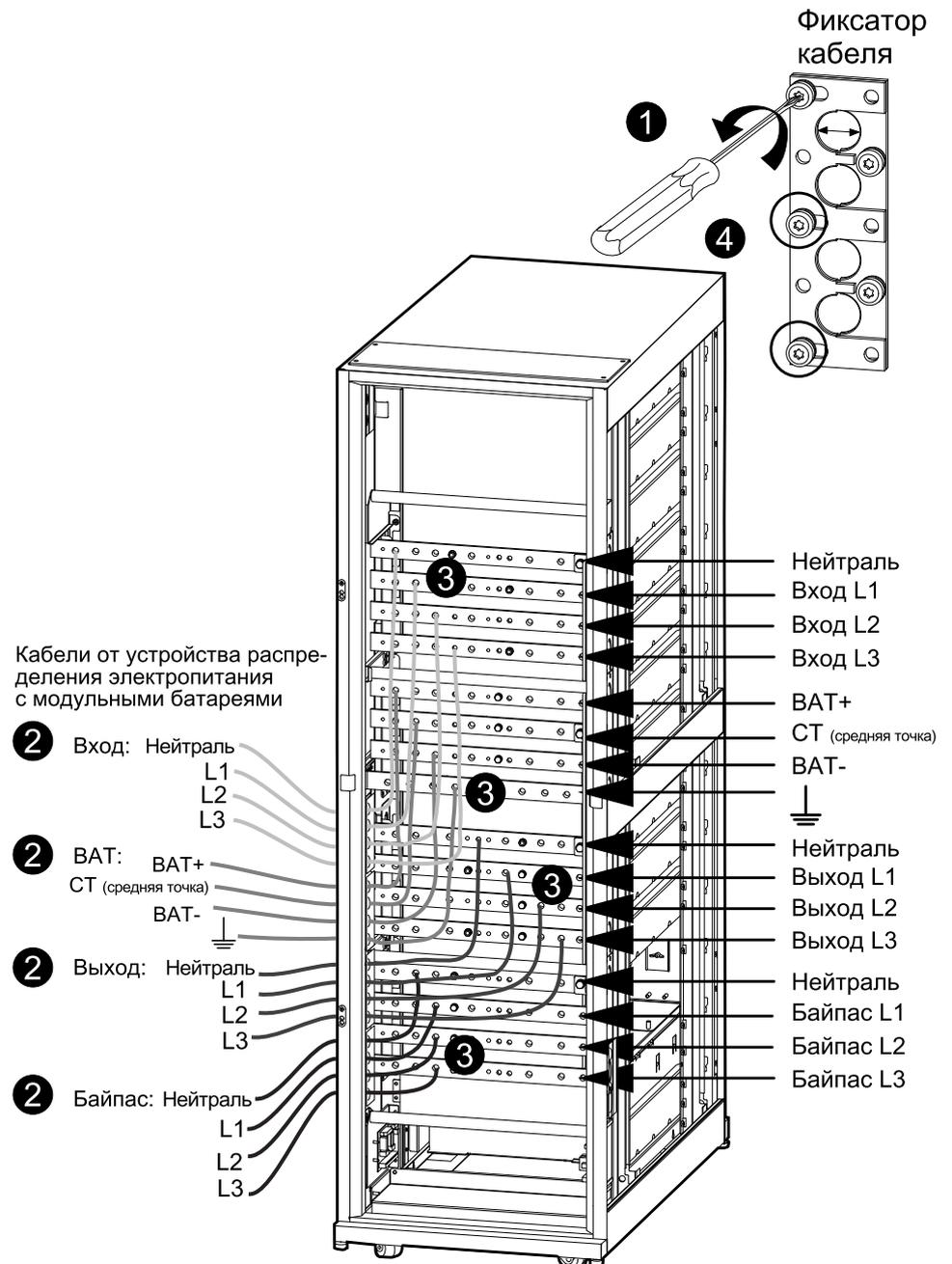
1. Прежде чем пропустить кабели, ослабьте три винта на каждом ближнем к шкафу распределения фиксаторе кабеля.
