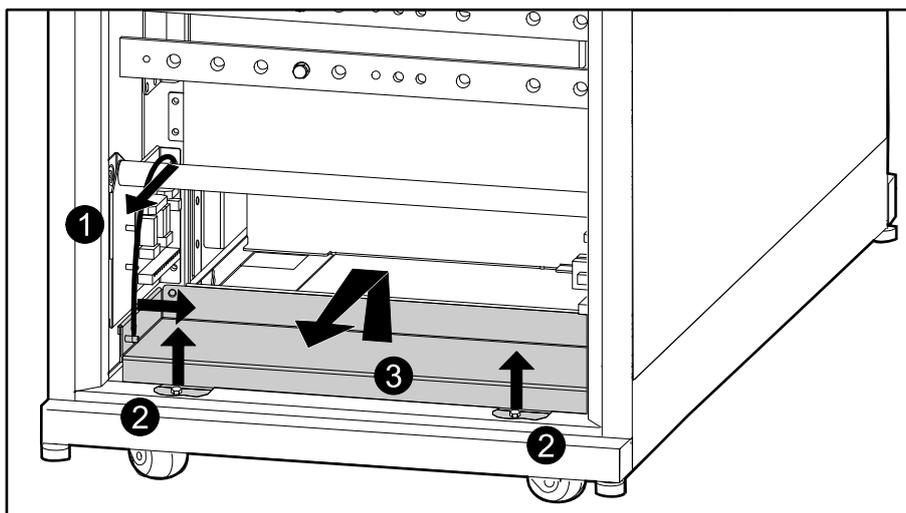
5. Установите нижнюю панель со смонтированными изоляционными трубами на место.
