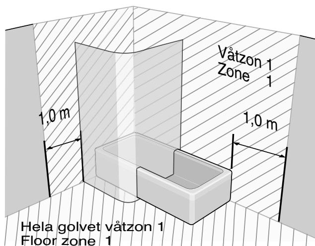
**Skruvinfästningar i våtzon 1 ska göras i massiv konstruktion såsom betong, reglar, särskild konstruktionsdetalj eller i Våtrumsvägg 2012.**
