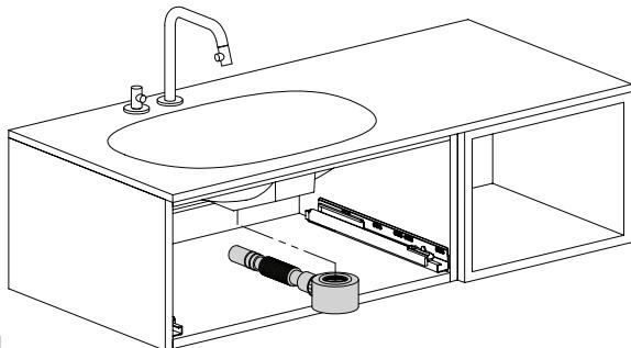
Fixez le siphon pour meubles (non inclus) et connectez les tuyaux maintenant. Le siphon doit être commandé séparément: numéro de l'article CL/06.53021
