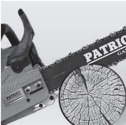
Не стоит придавать усилия при распиловке древесины, собственный вес пилы позволяет вести процесс распиловки. Если цепь зажало, остановите двигатель, приподнимите или измените положение бревна. Не стоит дергать инструментом для освобождения цепи.
