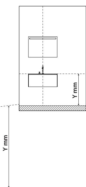
Markieren Sie mit einem Bleistift und mithilfe der Wasserwaage die gewünschte Höhe Y des Kommode. (Empfohlener Wert: Y = 900 mm)
