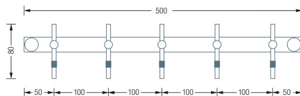
\*Material: PE (Polyethylen), matt schwarz. Hohe chemische Beständigkeit, gute Gleitfähigkeit.
