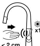
A los 3 seg. el grifo activará el paso de agua y el LED rojo emitirá 1 parpadeo por seg. durante 5 seg. dentro de los cuales se debe colocar la mano delante del sensor a menos de 2cm. El LED rojo pasará a estar activo y se cerrará el paso de agua.
