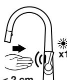
Tras 5 seg. el LED rojo se apagará y la distancia de detección habrá quedado fijada a un nuevo valor (2-10cm). Si no se presenta la mano frente al sensor o si se retira antes de los 5 segundos, el grifo quedará fijado con la distancia de detección más grande posible.
