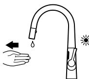
Cuando el LED rojo del sensor empiece parpadear, retirar las manos. El paso de agua debe interrumpirse si estaba abierto.
