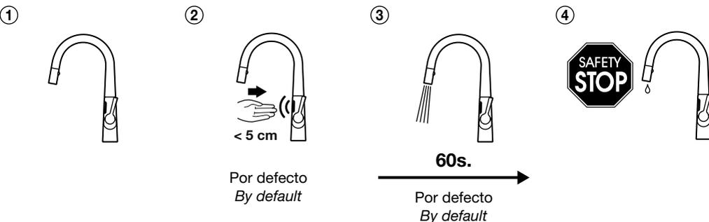
**ES** El flujo de agua se interrumpirá automáticamente pasados 60 segundos de su activación (ajuste por defecto), como medida de seguridad.
