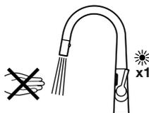
A los 3 seg. el grifo activará el paso de agua y el LED emitirá 1 parpadeo por seg. durante 5 seg. No colocar la mano.
