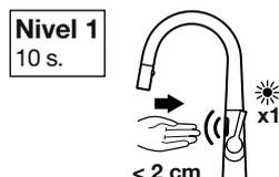
El LED emitirá 1 parpadeo por seg. durante 5 seg. Si se desea Nivel 1 (10 seg.), poner la mano a menos de 2cm del sensor. Si no se desea este ajuste, no colocar la mano.
