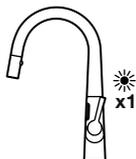
El LED emite un destello. Esperar 5 seg. para iniciar el proceso de ajuste.
