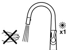
A los 3 seg. se activará el paso de agua y el LED emitirá 1 parpadeo por seg. durante 5 seg. No colocar la mano.
