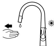
Cuando el LED del sensor empiece parpadear, retirar la mano. El paso de agua debe interrumpirse si estaba abierto.
