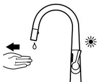
Cuando el LED rojo del sensor empiece parpadear, retirar las manos. El paso de agua debe interrumpirse si estaba abierto.
