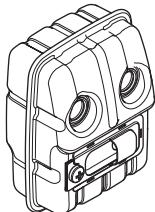
В странах с жарким и сухим климатом вероятность возникновения пожаров очевидна. Поэтому мы оборудуем некоторые глушители т.н. искроулавливающей сеткой. Проверьте, оборудован ли глушитель вашей машины такой сеткой.
