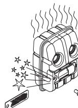
Если на вашем инструменте стоит глушитель такого типа, то сетку следует очищать не реже одного раза в неделю. На глушителях с катализатором, такую очистку достаточно производить раз в месяц. При возникновении повреждений на сетке ее следует заменить.
