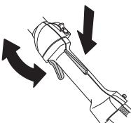
См. указания в разделе Запуск. Включите машину и полностью откройте дроссель. Отпустите рычаг дросселя и удостоверьтесь, что режущее оборудование останавливается и остается неподвижным. Если после постановки дросселя в положение холостого хода режущее оборудование продолжает вращаться, следует проверить регулировку холостого хода карбюратора. См. указания в разделе Техническое обслуживание.
