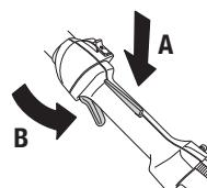
Проверьте, чтобы ручка газа в момент возвращения блокировочного рычага в исходное положение была блокирована на холостом ходу.
