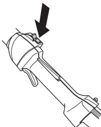
**ВНИМАНИЕ!** Контакт остановки автоматически возвращается в положение запуска. Во избежание непроизвольного запуска, колпачок зажигания следует всегда снимать со свечи зажигания при монтаже, проверке и/или обслуживании.
