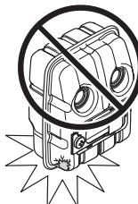
Периодически проверяйте, чтобы глушитель был надежно закреплен на корпусе машины.
