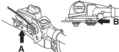
Натяните цепь, поворачивая винт натяжения цепи по часовой стрелке. Пользуйтесь
