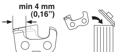
Общие рекомендации при установке снижения высоты ограничителя резания
