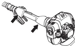
Система виброгашения машины снижает уровень вибрации передаваемый от двигателя или режущего оборудования на рукоятки.
