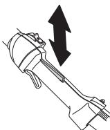
Проверьте, чтобы ручка газа и блокировочный рычаг перемещались свободно и чтобы возвратные пружины работали соответствующим образом.
