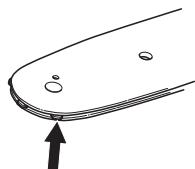
Проверка износа пильного механизма
