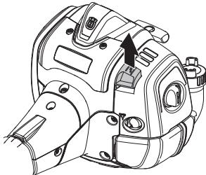
Снимите крышку воздушного фильтра и выньте фильтр. Очистите его струей воздуха.
