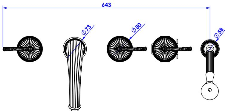
$\phi$  de perçage et entraxe recommandés.
