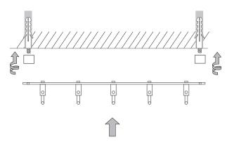
Sockel der Hakenleiste auf die herausstehenden Gewinde der Stockschrauben fest bis zur Wand aufdrehen. Dann Hakenleiste auf diese Sockel halten.
