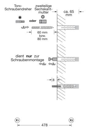
Unter Zuhilfenahme einer Wasserwaage 2 Bohrungen an X1 und mit Abstand von 478 mm an X2 vornehmen. Bohrerdurchmesser: 8 mm, Bohrlochtiefe: mindestens 60 mm. Sie können auch die Hakenleiste selbst zum Anzeichnen der Bohrlöcher verwenden.
