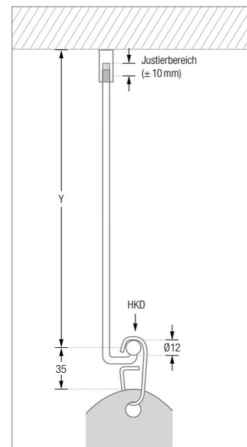
**▲ HINWEIS** Bei bodenebenen Duschen sollte sich die Duschvorhangstange bzw. der Duschvorhang idealerweise (ca. 5 cm) **innerhalb** der abgeschrägten Duschfläche befinden, damit das Wasser in der Schräge abtropfen kann. Nehmen Sie deshalb die Abmessung für die Raumhöhe X an dieser Stelle vor.
