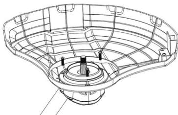
Для установки защитного кожуха поместите его на рабочую часть нижней штанги согласно рисунку. Плотно притяните защитный кожух тремя болтами.
