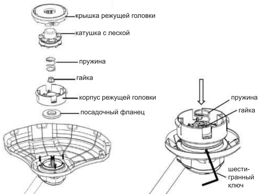
Для разборки режущей головки снимите крышку режущей головки, отжав два лепестка по краям корпуса. Аккуратно вытащите катушку с леской и пружину.
