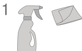
Die Oberfläche des zu verklebenden Untergrundes muss sauber, trocken, frei von Fett, Staub, Kalk und klebstoff-abweisenden Rückständen sein.
