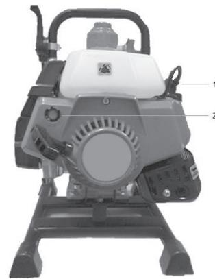
1. Колпачок свечи зажигания
