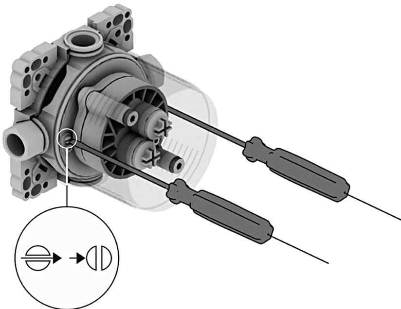
**DE** Die Richtung der Ein-/Ausgänge im Apparat kann geändert werden
