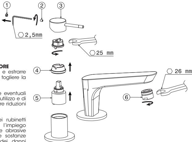
**I****INTERVENTI DI MANUTENZIONE****SOSTITUZIONE CARTUCCIA MISCELATORE E DEVIATORE**
