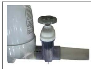
En el Spa Broadway Round hay dos válvulas de compuerta que impiden la circulación de agua hacia la bomba y el calentador. Cuando las válvulas están cerradas, permiten la inspección, la reparación e incluso la sustitución de equipamiento en un spa lleno de agua.
