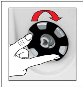
**Todos los jets son regulables.** Se puede intensificar el hidromasaje girando los jets en el sentido de las agujas del reloj (alrededor de 90°); girando los jets en dirección contraria se disminuye gradualmente la intensidad del hidromasaje hasta llegar al punto de cierre completo de los mismos.
