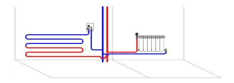
Нагревательный прибор в высокотемпературной системе. Температура в помещении регулируется сервоприводом под управлением комнатного термостата, что исключает влияние конвективных потоков на терморегулятор.
