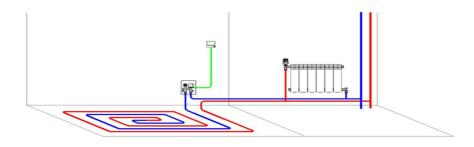
Теплая стена в высокотемпературной системе. Температура в помещении регулируется термоголовкой (высота установки монтажного комплекта 1,5 м).
