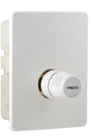
Модули **VT.ICBOX** позволяют подключать низкотемпературную систему к первичному контуру отопления без насосно-смесительного узла. При использовании модулей для регулирования работы отопительных приборов не требуется установка терморегуляторов непосредственно на радиаторах и конвекторах, повышается качество терморегуляции (отсутствует влияние конвективных потоков).
