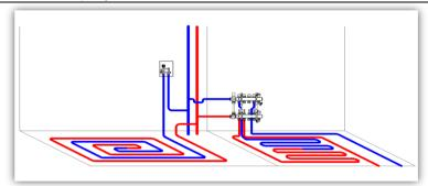
$ICBOX\ 2.0.$  «Теплый пол» в низкотемпературной системе. Температура в помещении регулируется термоголовкой (высота установки монтажного комплекта -1,2 м)..
