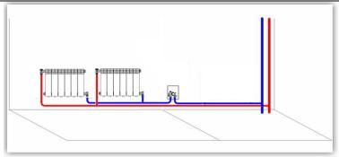
$ICBOX\ 4.0\$ Терморегулирование группой радиаторов в высокотемпературной мсистеме отопления
