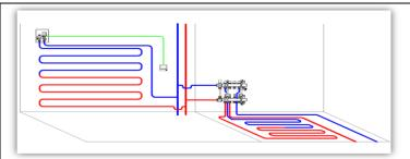
$ICBOX\ 5.0.$  «Теплая стена» в низкотемпературной системе. Температура в помещении регулируется сервоприводом под управлением комнатного термостата.
