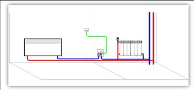
$ICBOX\ 5.0.$  Нагревательный прибор в высокотемпературной системе. Температура в помещении регулируется сервоприводом под управлением комнатного термостата.
