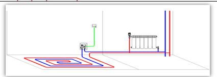
$ICBOX\ 1.0.$  «Теплый пол» в высокотемпературной системе. Температура в помещении регулируется сервоприводом под управлением комнатного термостата.
