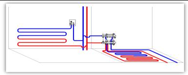
ICBOX~2.0. «Теплая стена» в низкотемпературной системе. Температура в помещении регулируется термоголовкой (высота установки монтажного комплекта 1,5 м).
