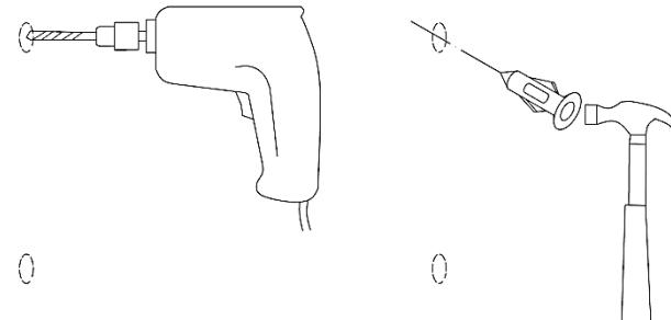
6- Fissare gli attacchi a muro con le viti in dotazione/ Attach the wall mountings to the supplied screws/ Прикрепите настенные крепления к прилагаемым винтам.
