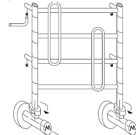
8- Sfiatare, anche più volte fino al corretto riscaldamento, agendo sugli sfiati superiori/ Breathe, even several times until proper heating, by acting on the upper vent/ Дышите, даже несколько раз, до надлежащего нагрева, действуя на верхнее отверстие
