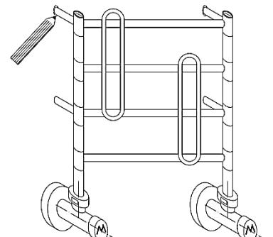
5- Smontare l'articolo, forare ed inserire i tasselli in dotazione/ Remove the item, drill and insert the supplied dowels/ Снимите деталь, сверлите и вставьте прилагаемые дюбели.
