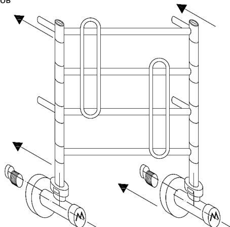
4- Dopo aver appoggiato l'articolo alla parete segnare le posizioni per gli attacchi a muro superiori/ After placing the article on the wall, mark the positions for the upper wall connections/ После помещения изделия на стену отметьте положение для верхних стенных соединений.
