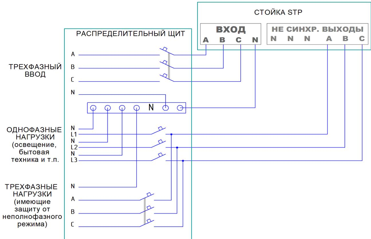
Рисунок 1. Рекомендуемая схема подключения Стойки STP к сети.
