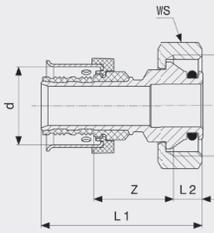
**Переход на резьбовые соединения Viega Smartpress**
