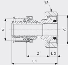
**Переход на резьбовые соединения Viega Smartpress**
