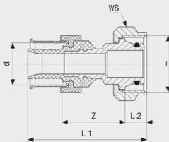
**Переход на резьбовые соединения Viega Smartpress**
