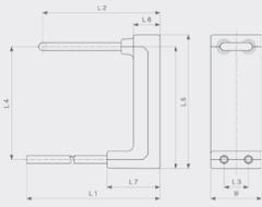
**Блок подключения радиатора Viega Smartpress**
