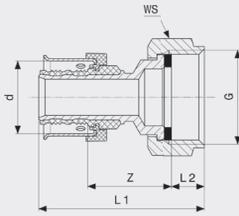
**Переход на резьбовые соединения Viega Smartpress**
