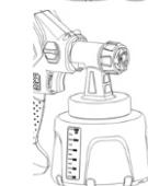
9. Очистите контейнер, всасывающую трубку, воздушную головку и сопло при помощи чистящей щетки и подходящего моющего раствора.
