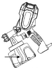
Если вы собираетесь распылять по направлению вверх, загнутый конец всасывающей трубы должен быть направлен к задней части пистолета.
