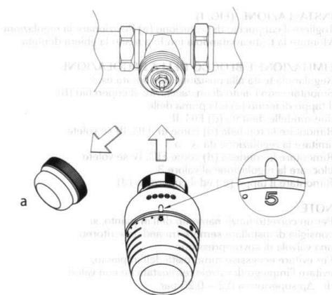
6.1. Термостатическая головка должна использоваться совместно с термостатическими клапанами, выполненными по стандарту HD 1215-2 Part2 и EN 215-1 part1 и имеющими на корпусе знак соответствия
