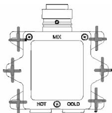
**IT** Predisposizione per fissaggio a strutture: cartongesso, legno, ecc.
