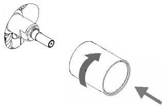
**IT** Attenzione! Il particolare non deve essere avvitato fino a battuta.**EN** Attention!! Screw on the part till the stop.**FR** Attention!! Visser la pièce jusqu'à l'arrêt.**DE** Achtung!! Schrauben Sie das Teil zum Stillstand ein.**ES** Cuidado!! Atomillar la pieza hasta el tope.RUBINETTO D'ARRESTO - STOP VALVE - ROBINET D'ARRET
