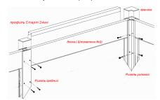
2) Сборку начинаем с торцевых стенок. Вверх ножками будет удобней. В угловой столбик вставьте торцевую стенку, одну или две, в зависимости от модели по направляющим и закрепить с помощью саморезов.
