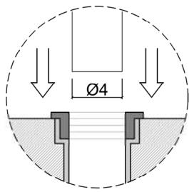
Predisporre scarico a pavimento per tubo Ø4cm
