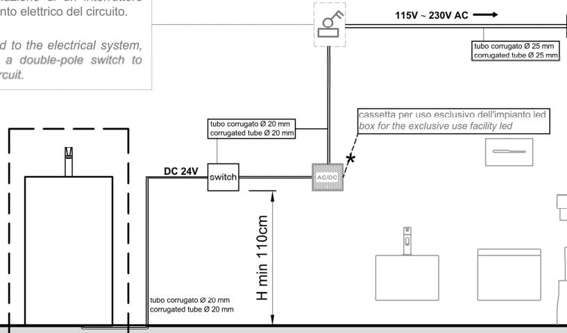
\* Collegare i cavi dell'apparecchio negli appositi morsetti dell'alimentatore rispettando la polarità.
