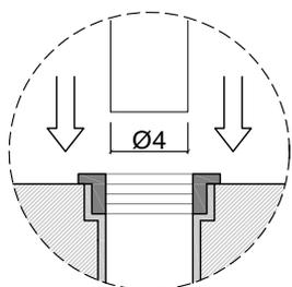
Predisporre scarico a pavimento per tubo Ø4cm
