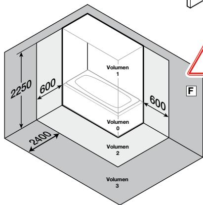
**ES** **A** La instalación eléctrica debe protegerse mediante un interruptor diferencial de  $I\Delta n$  0,03A y 25A de potencia y de un interruptor magneto térmico de 20A, situado fuera de los volúmenes del cuarto de baño.
