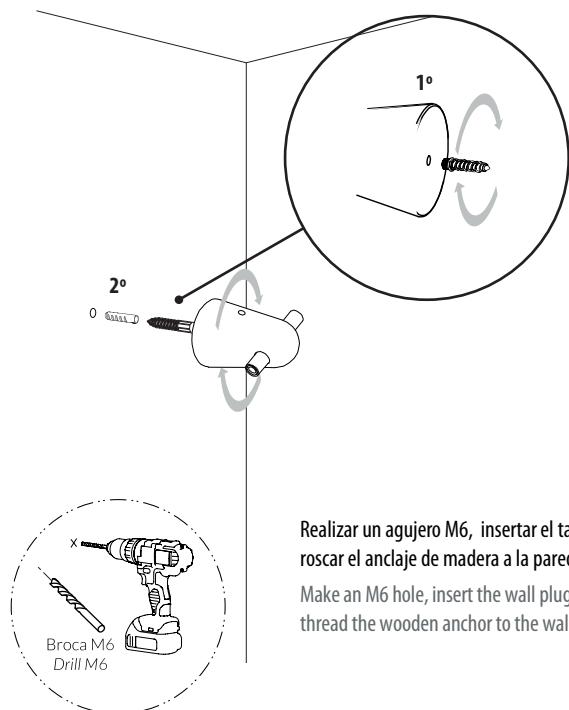
Realizar un agujero M6, insertar el tajo y roscar el anclaje de madera a la pared.
