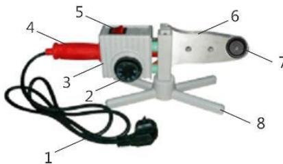
алюминиевого сплава. Внутри нагревательной панели встроено два независимых нагревательных элемента (ТЭНа) мощностью 750 Вт каждый. Любой из элементов может быть включен или выключен независимо отдельным выключателем (5) на панели управления аппарата. Геометрия нагревателя позволяет одновременно устанавливать на него сразу три сменные насадки (7). Мощности одного (любого из двух)
