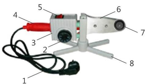
Сменные насадки (7) изготовлены из алюминиевого сплава с высокопрочным тефлоновым покрытием серого цвета, геометрия которых соответствует европейским нормативам DVS 2208.
