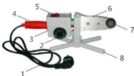
Сменные насадки (7) изготовлены из алюминиевого сплава с высокопрочным тефлоновым покрытием серого цвета, геометрия которых соответствуют европейским нормативам DVS 2208.
