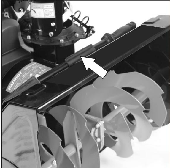
В случае если желоб забит снегом, прочистку желоба следует производить специальным инструментом.
