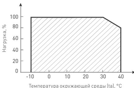
Рис. 2. Максимальная допустимая нагрузка, % от мощности источника.
