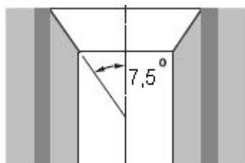
На внутреннем слое трубы должна быть снята фаска с размером катета 1,5-2 мм.
