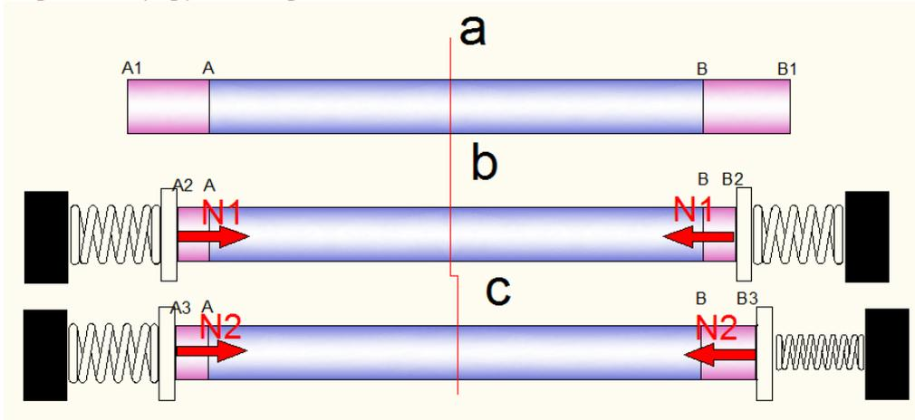
При незакрепленных концах труба удлинится на длину:
