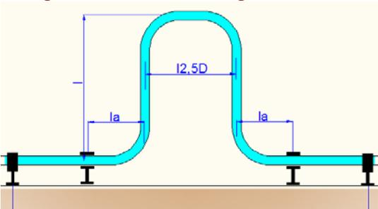
Для *П-образного и петлеобразного компенсаторов* плечом , компенсирующим удлинение участка *L*, будет являться участок *l*, длина которого может определяться по формулам для углового компенсатора с коэффициентом **0,71**, поскольку смещение каждого плеча составляет  $\Delta l/2$ . Расстояние между плечами П-образного компенсатора по технологическим соображениям принимается не менее  $12,5 D$ .
