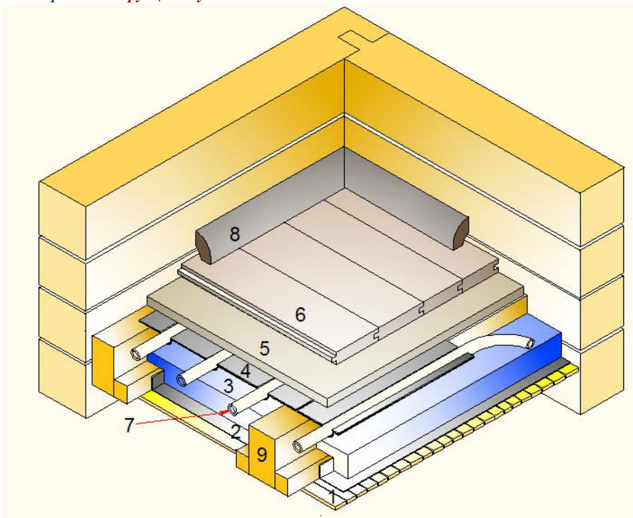
1 – потолочная подшивка; 2-пароизоляция; 3 – слой утеплителя; 4 – теплораспределяющие панели из алюминия или оцинкованной стали; 5 – «черный пол» из листового материала (ГВЛ; ДСП, фанера и т.п.); 6 – чистовое напольное покрытие; 7- трубы теплого пола; 8 –плинтус; 9 –балки перекрытия.
