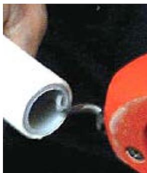
При использовании штыревого фаскоснимателя, его изогнутый нож прислоняется к внутренней кромке трубы, и производятся круговые движения.
