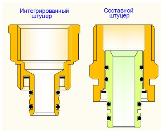
Ряд производителей выпускают фитинги для металлополимерных труб с составным штуцером (рис.3.3.5.р.1).
