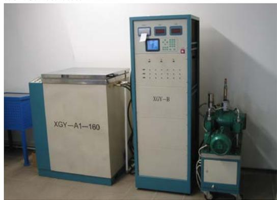
На стенде статических испытаний (рис.2.4.3.р.3), состоящем из насоса высокого давления, термостатической ванны и блока управления с принтером, производятся испытания образцов труб и фитингов на стойкость при постоянном внутреннем давлении (вода в воде) в соответствии с ГОСТ 24157.
