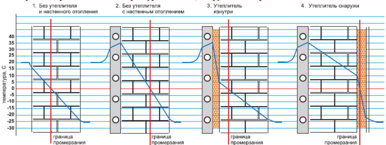
При новом строительстве экономически целесообразным может оказаться вариант, когда утеплитель расположен со стороны улицы (4). В этом случае точка промерзания смещена в толщу утеплителя, поэтому ограждающие конструкции могут выполняться из неморозостойких материалов. Минусом такого решения является то, что кроме энергозатрат на непосредственное отопление помещений, существенная доля тепловой энергии тратится на прогревание ограждающих конструкций.
