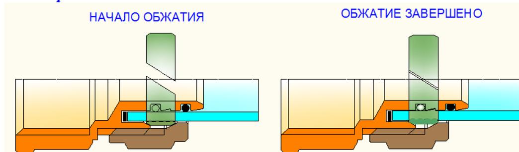
**Рис.3.4.р.3. Различие обжимных колец**
