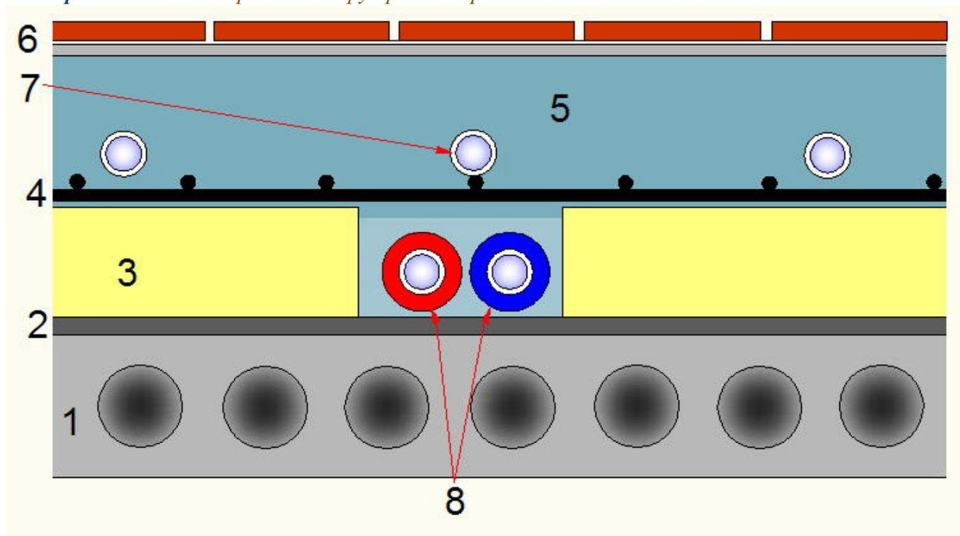
*1 –основание (плита перекрытия); 2 – пароизоляция; 3 – утеплитель (пенополистирол); 4 – арматурная сетка; 5 – цементная стяжка; 6 – чистовой пол; 7- трубы петлей «теплого пола»; 8 – трубопроводы радиаторного отопления в изоляции.*
