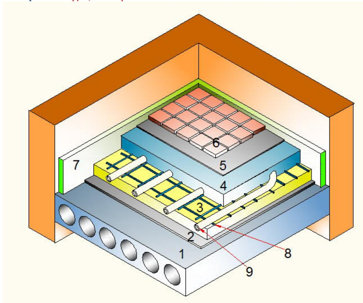
*1 – основание (плита перекрытия); 2 – пароизоляция; 3 – слой утеплителя (пенополистирол); 4 – цементно-песчаная или бетонная стяжка; 5- клеевой слой; 6 – чистовое напольное покрытие; 7 – демпферная лента; 8 – арматурная сетка; 9 – трубы теплого пола.*
