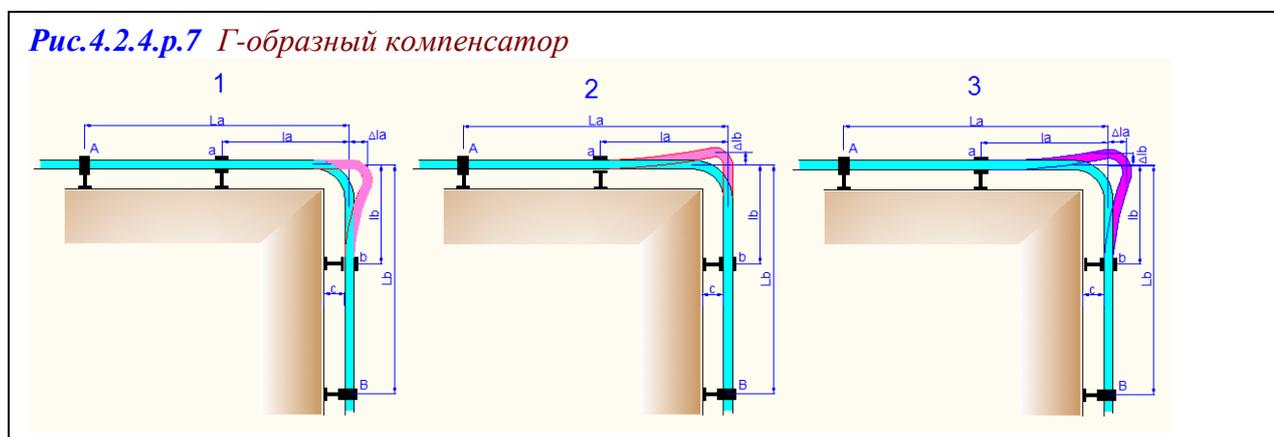
1. Для определения минимального расстояния до подвижной опоры  $b$ , считаем, что температурное удлинение трубы происходит только на участке  $L_a$ , а плечо  $l_b$  является гибкой опорой (*рис.4.2.4.р.7-1*).
