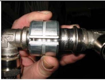
В результате произошло нарушение выполненного пресс-соединения (зазор между приложенными пресс-вкладышами составляет 5,5мм вместо допустимых 2-3 мм).
