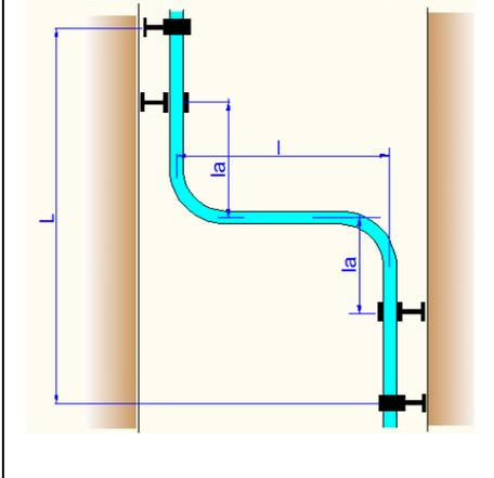
Для *Z-образного компенсатора* (рис.4.2.4. р.9) плечом , компенсирующим удлинение участка *L* будет являться горизонтальный участок *l*, длина которого может определяться по формулам для углового компенсатора. Определив *l*, можно рассчитать минимально допустимое расстояние до подвижных опор *l<sub>a</sub>*, которые должно компенсировать удлинение участка *l* ( $\Delta l/2$ ).
