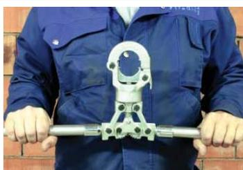
Для установки в инструмент пресс-вкладышей требуемого размера, ручки инструмента надо развести на 180°.
