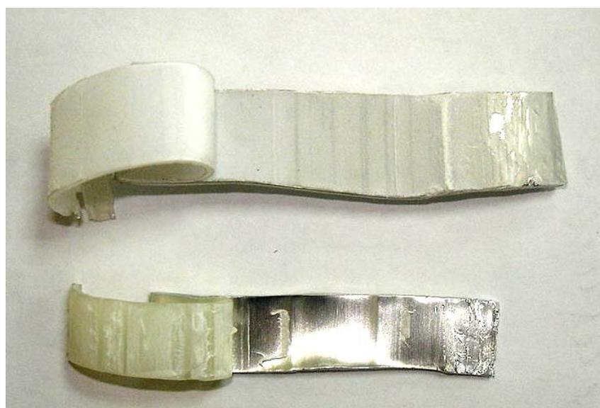
Качество клея наглядно проявляется при разрывном испытании трубы. Разрушение металлополимера при слабом клее происходит с образованием водяного пузыря между внутренним слоем и алюминием. Чем обширнее участок отслоения, тем слабее клей.
