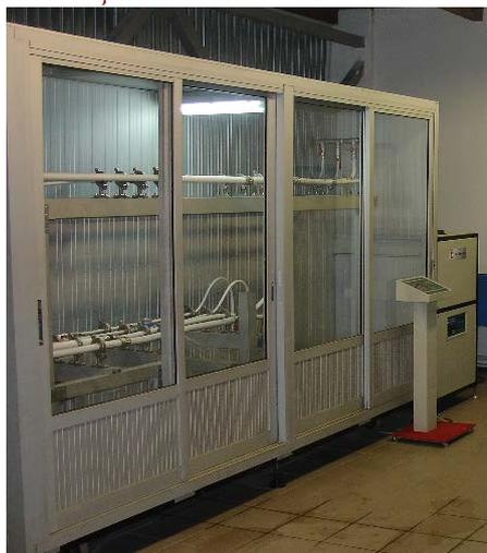
Качество соединения трубы с фитингами проверяется на стенде циклических испытаний (рис.2.4.3.п.5). Этот стенд состоит из испытательной камеры, циркуляционно-повысительного насоса, электронагревателя, chillera и программируемого пульта управления. Образцы труб с фитингами испытываются на циклическое изменение температуры при постоянном внутреннем давлении и на циклическое изменение давления при постоянной температуре по стандартной программе (таблица 2.4.3.т.4).
