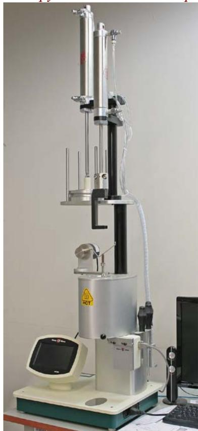
определяется в соответствии с ГОСТ 11645 на экструзионном пластомере (рис.2.4.3.п.1), состоящем из нагреваемой экструзионной камеры, поршня, пригруза и капиллярного сопла. Образец сырья помещается в камеру и нагревается до требуемой температуры. Под воздействием эталонного пригруза расплав выдавливается через сопло. Весовое количество выдавленного расплава и является показателем текучести расплава.
