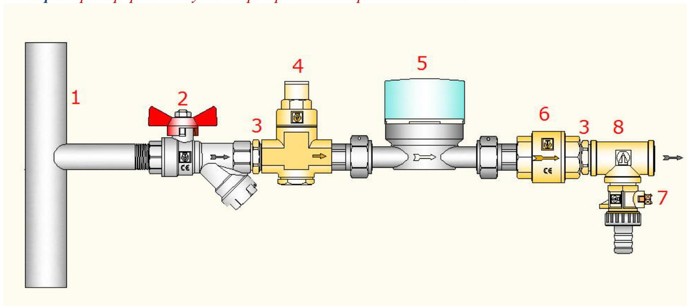
1 – водопроводный стояк; 2 – шаровый кран со встроенным фильтром; 3 – ниппель резьбовой; 4 – редуктор давления; 5 – водосчетчик с присоединительными полусгонами; 6 – клапан обратный; 7 – кран дренажный со штуцером (ставится на холодной воде и используется для присоединения шланга, как первичное средство пожаротушения (п. п.7.1.11 СП 30.13330.2012) ); 8 – тройник резьбовой.
