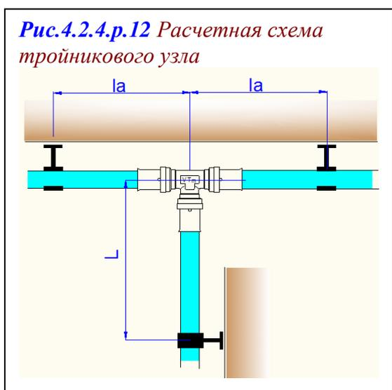
Для тройниковых узлов минимальное расстояние до подвижных опор транзитного участка определяется исходя из условия не превышения максимально допустимого изгибающего момента на тройниковый соединитель от удлинения участка  $L$ .
