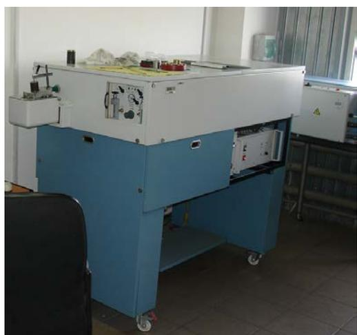
*Химический состав* латуни корпусов фитингов и нержавеющей стали пресс-гильз контролируется с помощью атомно-эмиссионного оптического многоканального спектрометра (**Рис.2.4.3.р.7**).
