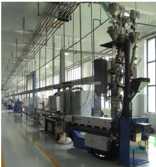
Металлополимерные трубы VALTEC производятся на автоматических экструзионных линиях компании *Maillefer Extrusion* (Швейцария, Финляндия) (рис.2.4.1.р1). Описание технологического процесса производства труб приведено в таблице 2.4.1.т.1.
