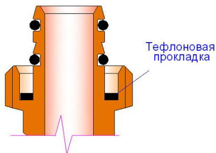
Прокладки из тефлона, которыми комплектуются фитинги VTm.300 (рис.3.3.4.р.1), предотвращают электрический контакт между латунью соединителя и алюминием соединяемой трубы.
