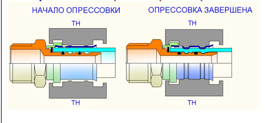
Пресс-фитинги VTm.200, рассчитанные на опрессовку насадками типа «ТН» (по каталогу REMS), в зонах, где действуют сосредоточенные радиальные усилия, имеют прямоугольные выточки, в которые при запрессовке вдавливается полиэтилен внутреннего слоя. Таким образом, создается прочное несползающее соединение (рис.3.5.р.2). Если теперь срезать
