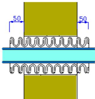
В местах прохода металлополимерных труб через стены, перегородки и перекрытия, труба должна быть заключена в защитный пластиковый гофрированный кожух.
