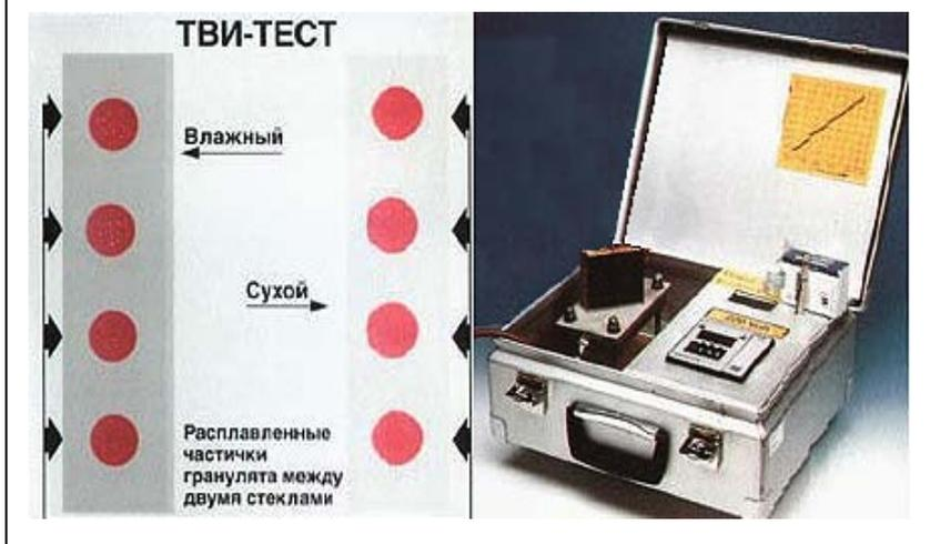
**Рис.2.4.3. п.2а Влагомер Hydrotracer**
