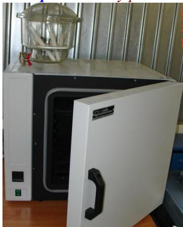
Испытания на термическую стабильность проводится в муфельной печи (рис.2.4.3.п.4). Образцы труб, снабженные запорными шаровыми кранами, предварительно заполняются водой под испытательным давлением и помещаются в муфельную печь, в которой поддерживается заданная температура с точностью  $\pm 1^\circ\text{C}$ . Каждый образец выдерживается в камере при температуре воздуха  $110^\circ\text{C}$  при начальном напряжении в стенке трубы 2,5 МПа.
