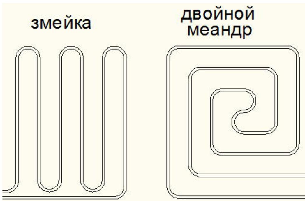
Трубы теплого пола нужно раскладывать таким образом, чтобы теплоноситель сначала поступал к наиболее холодным зонам помещения (окна, наружные стены). У стен, вдоль которых планируется расстановка мебели, трубы теплого пола следует укладывать на расстоянии 300 мм от стены.
