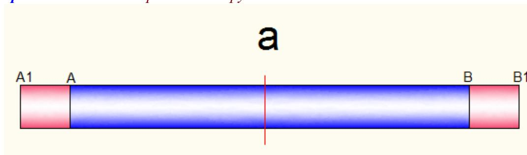
Если продольные перемещения концов отрезка ограничены жесткими (неподвижными) опорами (*рис.4.2.4.р.2*), то деформация температурного передается на сам отрезок: он испытывает осевое сжатие с силой  $N$ , приводящей к его мнимой деформации  $\Delta L$ .
