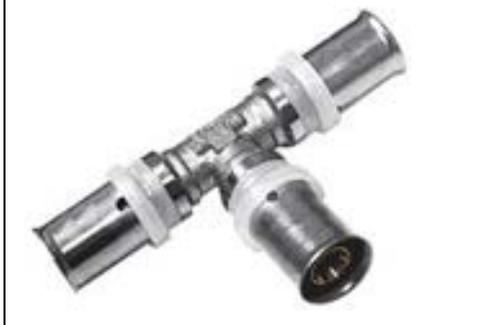
Принцип создания пресс-соединения заключается в радиальном обжатии металлополимерной трубы на штуцере с помощью специального пресс-инструмента. Фиксация опрессовки обеспечивается гильзой из нержавеющей стали, латуни или алюминия.
