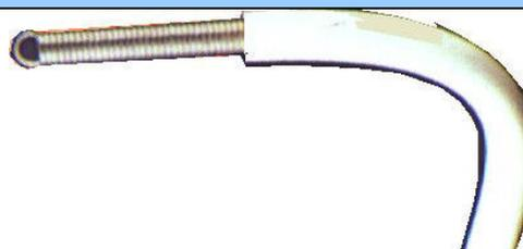
Кондуктор пружинный внутренний
