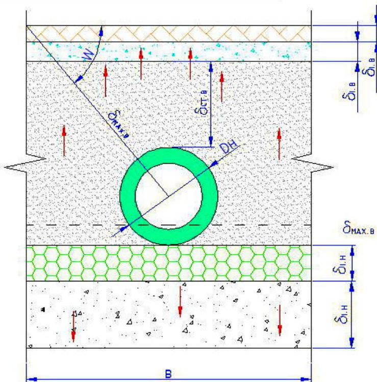
Термическое сопротивление слоев пола над трубой:
