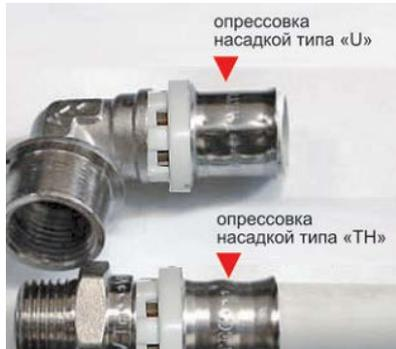
Запрессовка произведенная насадкой неподходящего профиля («U» вместо «ТН»). Вторичная запрессовка для ликвидации «защипа» не производилась. В результате все соединения оказались негерметичны.
