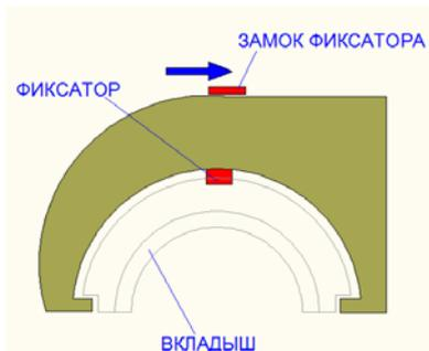
*Особенности конструкции: опрессовка производится до полного смыкания рукояток. Не выполнив этого условия, клещи раскрыть невозможно.*
