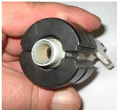
Некачественная запрессовка фитинга (зазор между пресс-вкладышами составляет 4 мм, вместо допустимых 2-3 мм). Ошибка вызвана несоблюдением режима работы электроинструмента. Его перегрев привел к ослаблению усилия обжатия.
