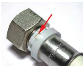
Подготовленная труба одевается на штуцер фитинга так, чтобы уплотнительные кольца не потеряли проектного положения. Труба надевается до тех пор, пока она не станет видна в контрольном окошке обжимной обоймы.
