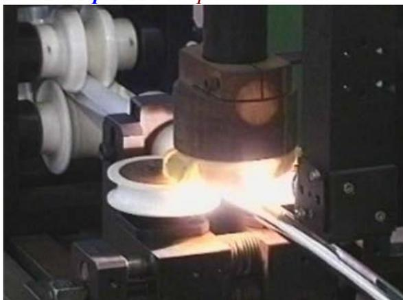
**1. Сварка неплавящимся электродом в среде инертного газа (TIG) (рис.2.4.2.р.1).** Этот вид сварки позволяет сваривать фольгу практически любой толщины, начиная с 0,3мм. К недостаткам данного метода следует отнести необходимость использования инертных газов, периодической замены электродов и теоретическую возможность прожига алюминия при отказе автоматики
