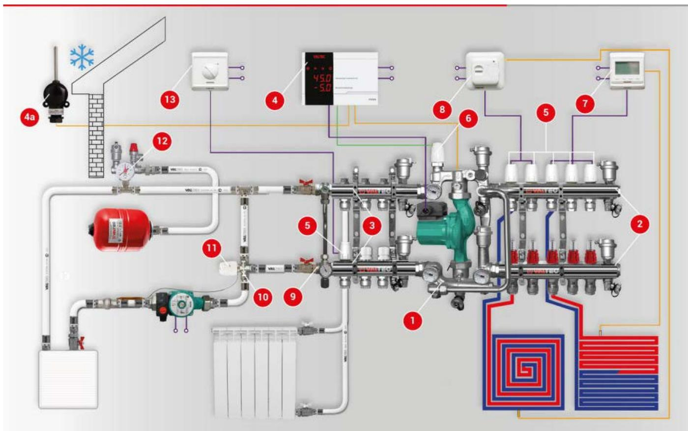
1 –насосно-смесительный узел Combi.S; 2 –коллекторный блок VTc.596; 3- коллекторный блок VTc.594; 4 – контроллер K.200.M; 5 –сервопривод VT.TE3040; 6 –сервопривод VT.TE3061; 7 – хронотермостат VT.AC709; 8 – термостат VT.AC602; 9- байпас с перепускным клапаном VT.0667T; 10- кран трехходовой MR.03; 11 – термоголовка с выносным датчиком VT.5012; 12 – группа безопасности VT.460; 13 – комнатный термостат VT.AC601.
