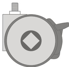
**HINWEIS** Durch das Ersetzen der FüÙe gegen Bodenrollen ergibt sich eine Erhöhung von 4,5 cm. Tragfähigkeit von 50 kg/Rolle.
