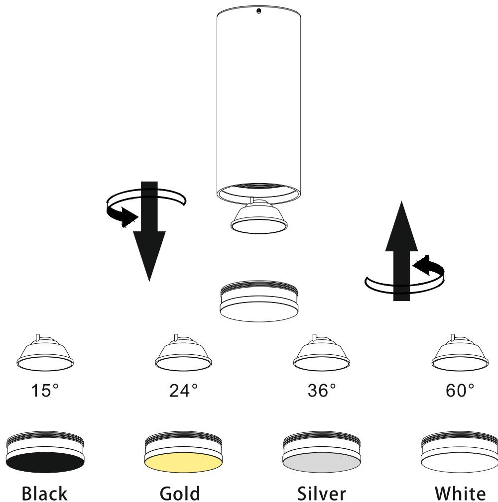
Открутите дефлекторное кольцо и извлеките его из светильника, покачивающими движениями извлеките рефлектор. Сборка производится в обратном порядке.
