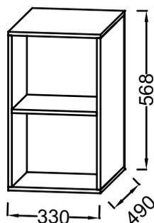
Descriptif CCTP : Caisson annexe. EB2528. Collection : ODÉON RIVE GAUCHE. DIMENSIONS : 33 x 49 x 56,80 cm. POIDS : 11,5 kg. MATÉRIAU : Plaqué bois. TYPE D'INSTALLATION : Suspendu. RANGEMENT : Rangements complémentaires.
