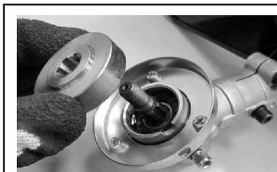
Установите защитный фланец на триммерную головку.
