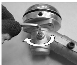
Шестигранным ключом закрутите болт редуктора. Не прилагайте большое усилие при закручивании болта, т.к. корпус редуктора сделан из алюминия, и при сильном усилии затягивания резьба на корпусе редуктора может срезаться.
