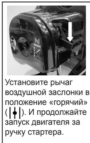
Установите рычаг воздушной заслонки в положение «горячий» (↓↑). И продолжайте запуск двигателя за ручку стартера.
