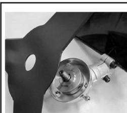
Установите на защитный фланец режущий нож.
