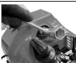
Комбинированным ключом открутите свечу зажигания против часовой стрелки.
