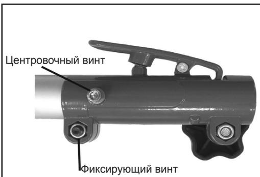
С другой стороны верхней половины штанги установите разъемное соединение. Выкрутите центровочный винт и совместите отверстие центровочного винта с отверстием на штанге. Закрутите центровочный винт. Центровочный винт должен попасть в отверстие штанги. Зафиксируйте соединение штанги фиксирующим винтом.
