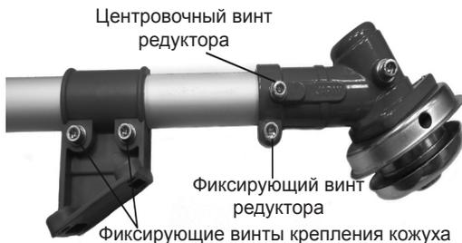
**Примечание!** Нижняя половина штанги с одной стороны имеет центровочное круглое отверстие со стороны редуктора и отверстие прямоугольной формы с другой стороны.
