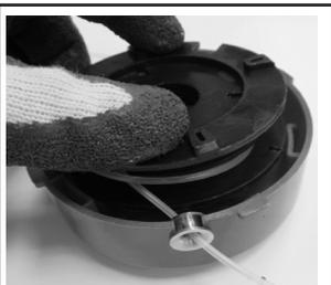
Установите шпулю в корпус катушки, предварительно заправив концы лески в выходные отверстия на корпусе катушки.
