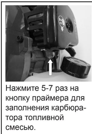
Нажмите 5-7 раз на кнопку праймера для заполнения карбюратора топливной смесью.
