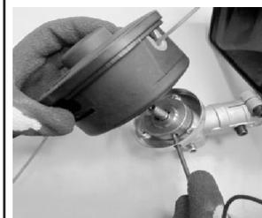
Совместите отверстия на защитном кожухе и защитном фланце триммерной головки. Вставьте шестигранный ключ в отверстие кожуха, заблокировав вал, и накрутите катушку на вал триммерной головки.
