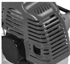
Вентиляционные отверстия на корпусе двигателя, а также ребра охлаждения цилиндра во время работы могут забиваться сухой травой. Это может привести к перегреву двигателя. Поэтому периодически прочищайте вентиляционные отверстия и ребра охлаждения цилиндра кисточкой или сжатым воздухом.
