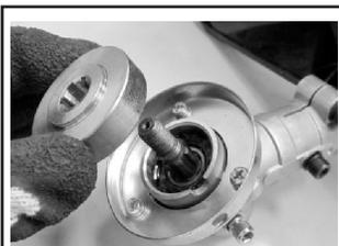
Установите защитный фланец на триммерную головку.
