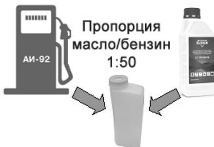
**Внимание!** Запрещается смешивать бензин с маслом в топливном баке триммера. Приготавливайте топливную смесь непосредственно перед работой. Не следует приготавливать топливную смесь в больших количествах, так как готовая топливная смесь имеет ограничение по сроку хранения. Готовая топливная смесь при длительном хранении (больше месяца) теряет свои свойства. Если в течение месяца топливная смесь не использована, то лучше ее утилизировать.
