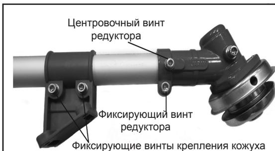
Снимите с концов штанги транспортировочные заглушки. Со стороны, где центровочное отверстие расположено ближе к краю штанги, установите на штангу крепление защитного кожуха, не затягивая винты крепления. Затем установите на штангу редуктор.
