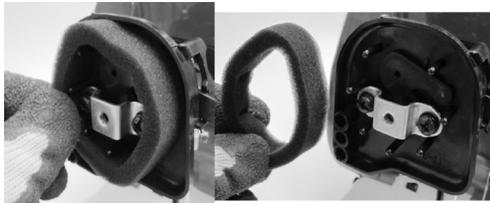
Снимите крышку воздушного фильтра и извлеките из корпуса воздушного фильтра фильтрующий элемент (поролоновую губку).
