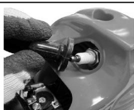
Снимите со свечи наконечник высоковольтного провода.
