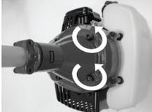
С помощью четырех болтов (входят в комплект) соедините штангу с двигателем. При правильной установке бензобак и триммерная головка должны смотреть в одну сторону.
