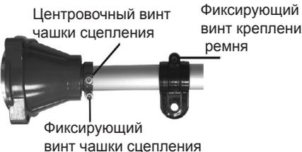
С другой стороны штанги установите на штангу крепление ремня и зафиксируйте фиксирующий винт. Затем установите на штангу чашку сцепления. Выкрутите центровочный винт чашки сцепления и совместите отверстие центровочного винта чашки сцепления с отверстием на штанге. Закрутите центровочный винт. Центровочный винт должен попасть в отверстие штанги. Зафиксируйте чашку сцепления на штанге фиксирующим винтом.
