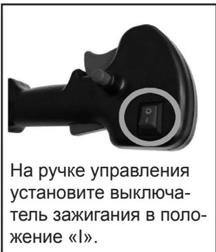
На ручке управления установите выключатель зажигания в положение «I».
