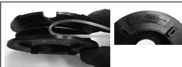
Возьмите отрезок лески длиной примерно 5м, сложите его пополам. Вставьте петлю лески в паз посередине шпули. Намотайте леску на шпулю в два ручья. Направление намотки лески указано стрелкой на корпусе шпули.
