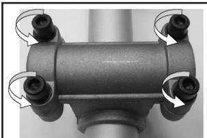
С помощью шести-гранного ключа открутите 4 винта крепления рукоятки управления к штанге.
