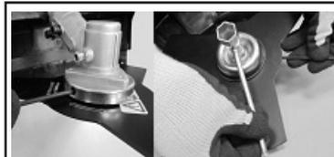
Совместите отверстия на защитном кожухе и защитном фланце триммерной головки. Вставьте шестигранный ключ в отверстие кожуха, заблокировав вал. Затяните гайку комбинированным ключом.
