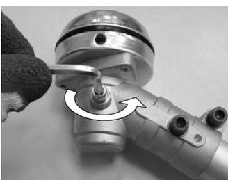
Шестигранным ключом открутите против часовой стрелки болт редуктора.
