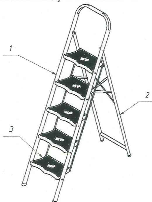
Тетива передней ноги и задней ноги выполнены из стального профиля, защищенного от коррозии порошковой краской. Задняя и передняя ноги соединены между собой. Ступени и нижние заглушки (ножки) выполнены из высокопрочного пластика и имеют противоскользящую ребристую поверхность.
