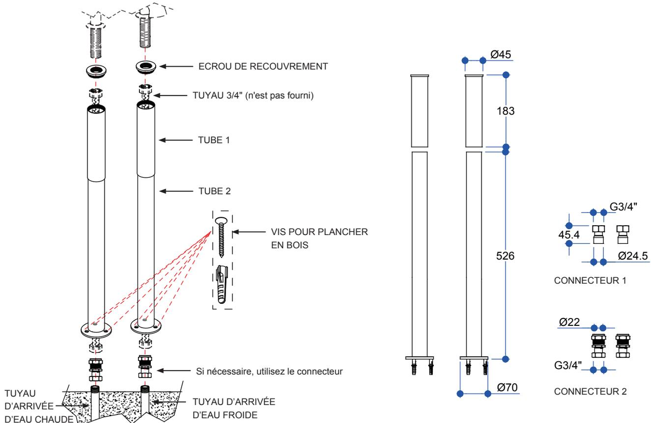
1. Avant l'installation, rincez le système pour garantir que les particules métalliques, la soudure et les autres saletés ne pénètrent pas dans le produit.
