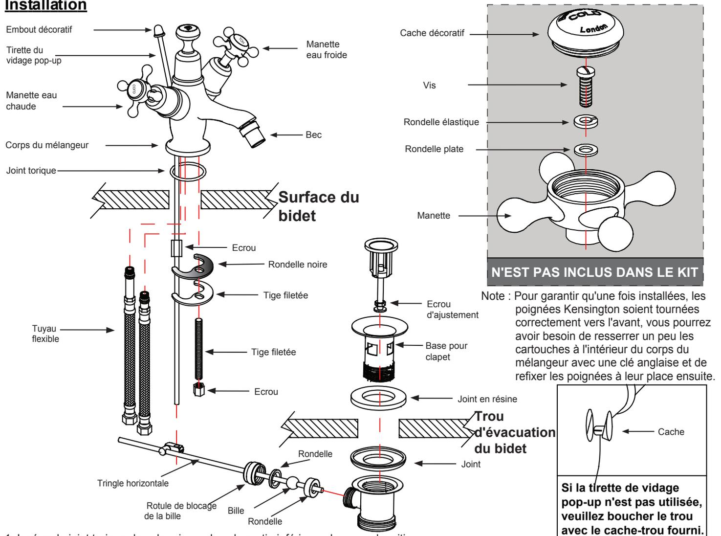
1. Insérez le joint torique dans la rainure dans la partie inférieure du corps du mitigeur.
