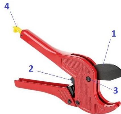
Корпус и рукоятки ножниц выполнены из силумина с покрытием эпоксидной эмалью. К корпусу через винтовую ось (3) подвижно крепится нож из нержавеющей инструментальной стали с храповиком (2). В закрытом положении нож фиксируется защёлкой (4). Шаговую работу храпового механизма обеспечивает собачка, подпружиненная пружиной.
